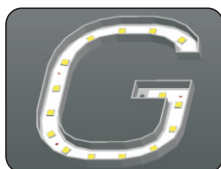
③ 按预定间距把软条安装在灯箱内
