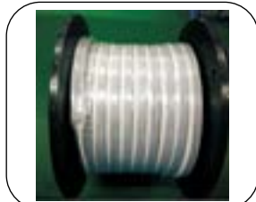
②. 产品卷装 OK 用 PE 膜将产品缠绕捆扎；
