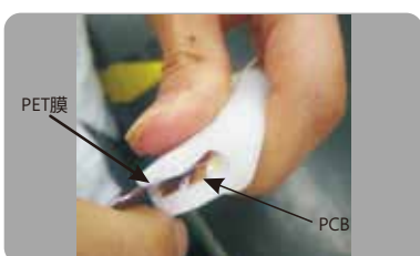
④ 采用美工刀，把PET膜剥离 PCB
