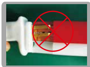
插针移位，易造成短路
