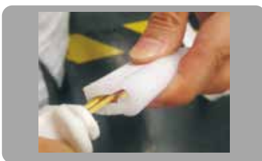
⑤ 将输入线插头对准PET膜与PCB之间，保证插针与PCB焊盘接触
