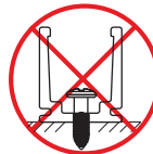
③. 灯带平整、牢牢低卡在安装卡上，即可；
