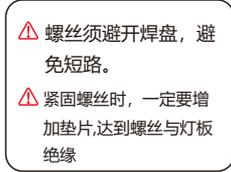
⚠ 螺丝须避开焊盘, 避免短路。
