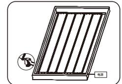
⑤ 确定安装无误后, 锁紧电源螺丝孔。
