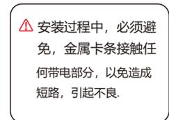
⚠ 安装过程中, 必须避免, 金属卡条接触任何带电部分, 以免造成短路, 引起不良。
