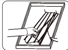
③ 撕掉产品上的离型纸, 按安装间距固定在灯箱底部。
