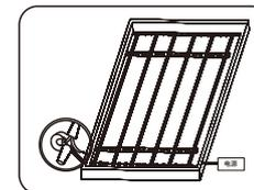
④ 如需裸线连接, 请使用连接端子; 接好电源及线头处理。
